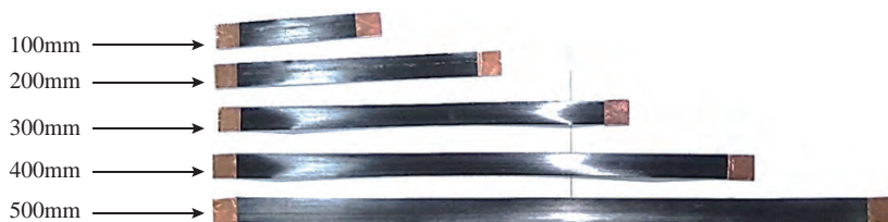
图5 不同长度的预浸带电阻值测试样件
